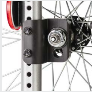
Radstandsverlängerung durch Drehen des Varioblockes nach hinten
